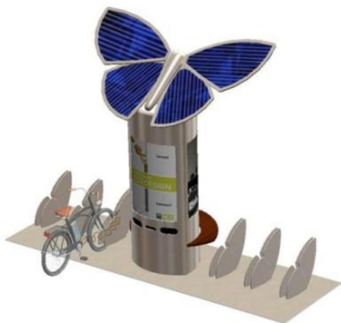
Model voor een oplaadzuil voor elektrische fietsen
